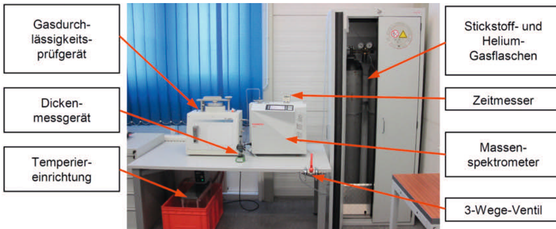
Bild 2. Aufbau des Atline-tauglichen Schnelltestsystems zur Permeationsmessung (Bild: SKZ)
